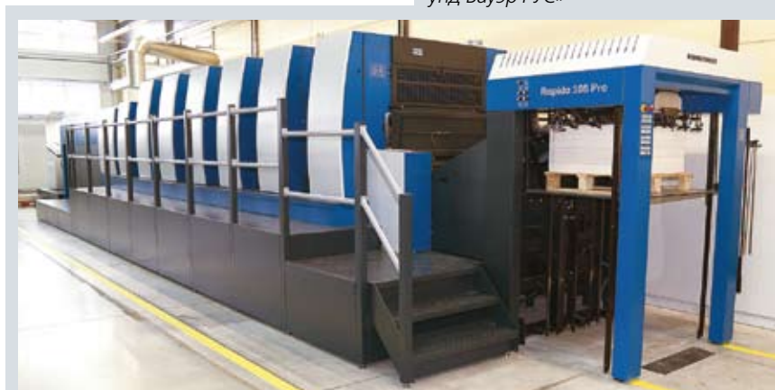
В январе 2019 г. в типографии «Люксупак» завершилась инсталляция 6-красочной офсетной машины Koenig&Bauer Rapida 105 Pro с секцией лакирования. Это первая в России машина, оснащенная встроенной системой контроля качества PDF Check
