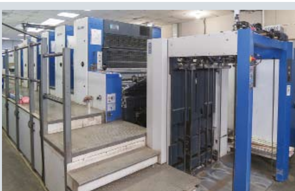
Как планировали в типографии ранее, пятикрасочную машину Rapida 105 дооснастили под УФ-печать, что открыло возможность работы с металлизированным картоном
