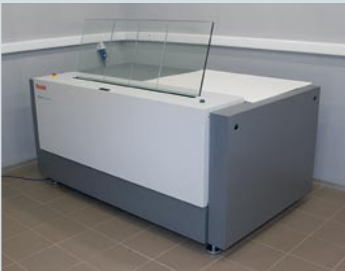
Не так давно в «ЛюксУпак» смонтирован первый в России допечатный комплекс на базе выводного устройства Kodak Achieve. Вывод форм в типографии ведется на беспроцессные пластины Kodak Sonora
