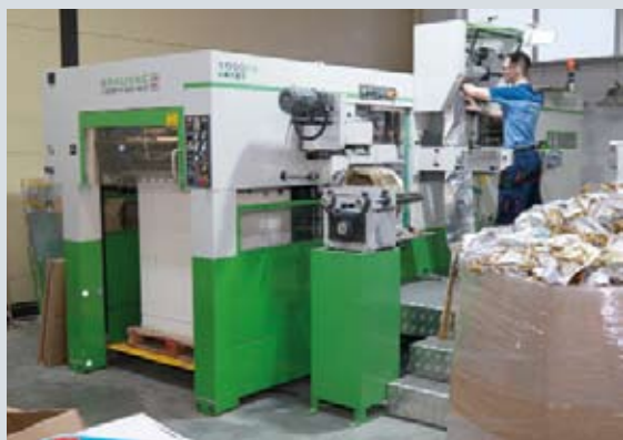
Машина для тиснения фольгой в типографии «Люксупак» от компании Brausse, которая входит в группу BOBST
