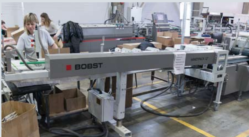
Парк фальцевально-склеивающих линий типографии состоит из машин компании Bobst. Некоторые из них оснащены устройством HandyPack, которое существенно упрощает приемку готовых коробок на высоких скоростях работы
