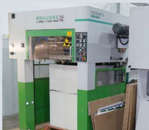
Тиснение фольгой в типографии «ЛюксУпак» выполняется на прессе Brausse. Эта компания имеет завод в Китае и входит в группу Bobst. Оборудование этого производителя в настоящее время может поставляться в Россию
