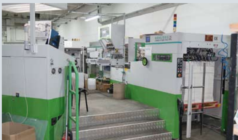
Тиснение фольгой в типографии «ЛюксУпак» выполняется на прессе Brausse. Эта компания имеет завод в Китае и входит в группу Bobst. Оборудование этого производителя в настоящее время может поставляться в Россию
