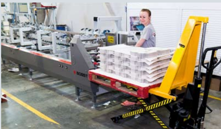
Для облегчения работы и повышения производительности труда на многих рабочих местах теперь устанавливаются вот такие тележки с автоматическим подъемом палеты с полуфабрикатами
