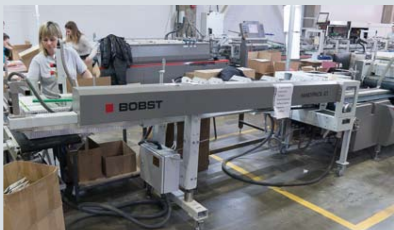
Одну из фальцевально-склеивающих линий Bobst оснастили модулем Handyrack GT. Система позиционирует коробки на транспортировочной ленте для более удобного их съема оператором
