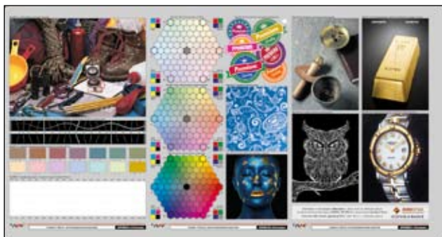
Рис. 3. Триадное изображение и каналы с металлизированными красками для второй стороны вкладки
